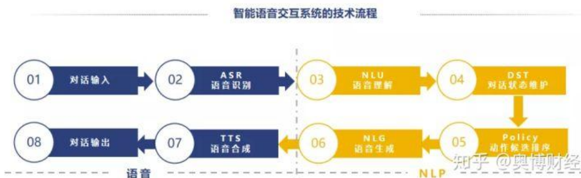
图：智能语音交互系统的技术流程
