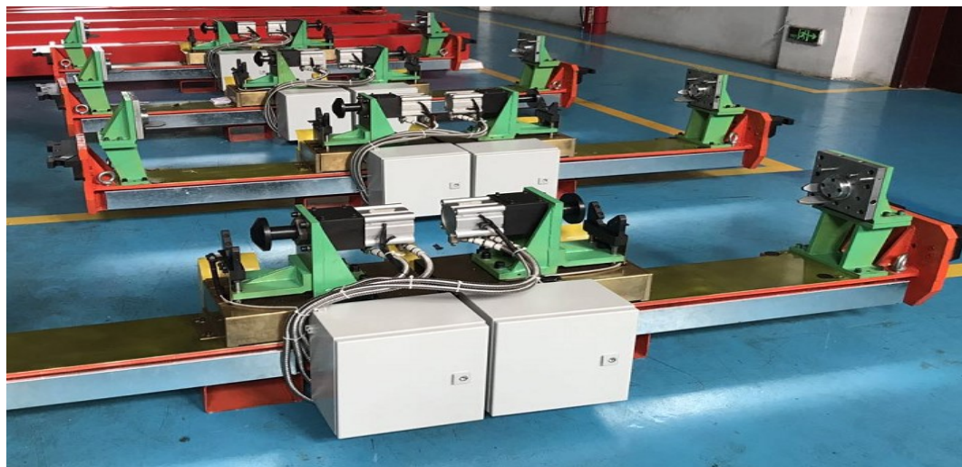
后桥壳焊接夹具
